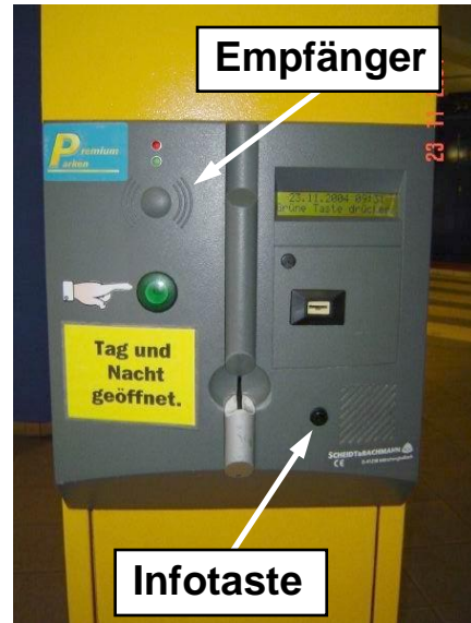
Ein- und Ausfahrtsgerät in den übrigen Stellplatzobjekten mit Dauerparkerfunktion (außer H 6 und Lortzingblock)
